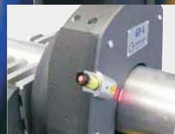
Puntero láser integrado para identificar el punto de corte
