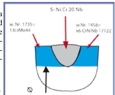
c) Ejemplo de una unión de un haz tubular entre un acero 1,25%Cr-0,5%Mo con un inoxidable 1,4580 (316Cb) que operan a temperaturas superiores a 450° C empleando un base Ni.
