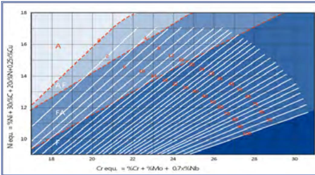
Diagrama WRC - 1992, que le permitirá poder determinar el FN de estos materiales. Modo operativo, solicite la Ficha de aplicación técnica.
