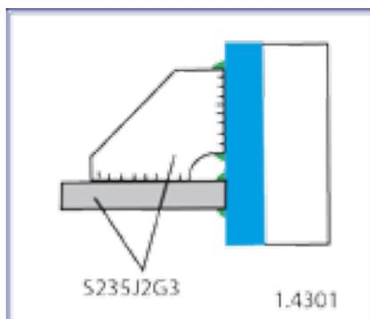
b) Ejemplo típico de la soldadura de refuerzo o soporte en la pared de un tanque de acero inoxidable 1.4301 (304) a un acero al carbono S235J2G3, donde la temperatura de trabajo será siempre inferior a los 400° C.
