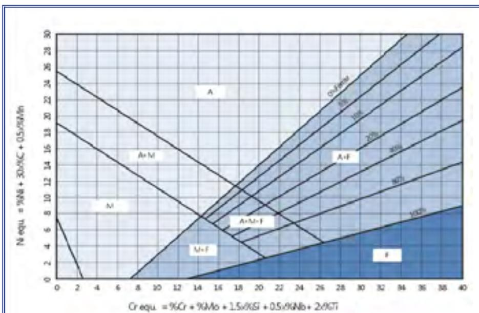
Diagrama de SCHAEFFLER, para conocer la forma operativa de dicho diagrama en la predicción y determinación del consumible y proceso más adecuado, solicite la Ficha de aplicación técnica.
