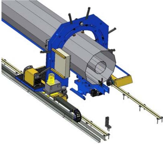
Clamp especial hidráulico para ensamblaje de diámetro. 250 a 1250mm
