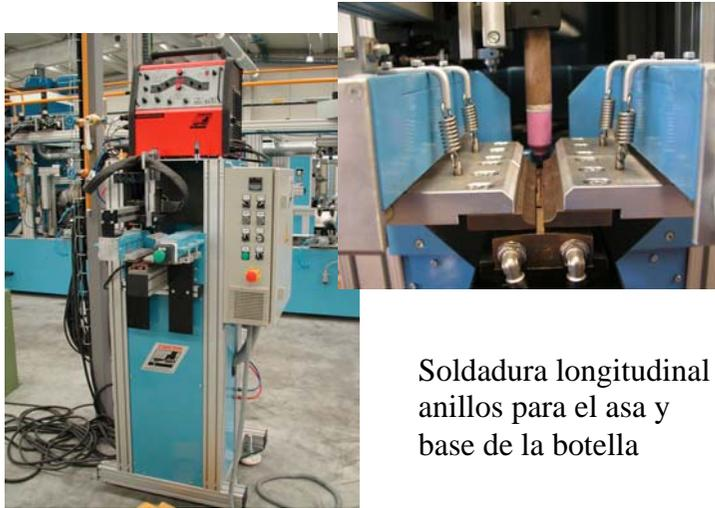
Soldadura longitudinal anillos para el asa y base de la botella
