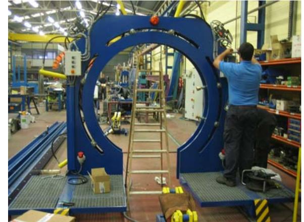
Columna de soldadura 2,5 x 1,8 con base motorizada para desplazamiento sobre rail con longitud 12Mtrs.
