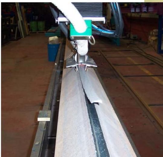
**Sistema mecanizado para la soldadura longitudinal de perfiles angulares de longitud 12Mtrs..**
