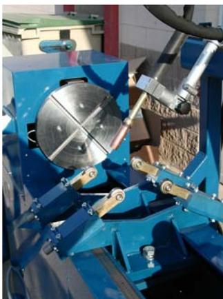
Equipo para soldadura de cilindros hidráulicos, compuesto por:
