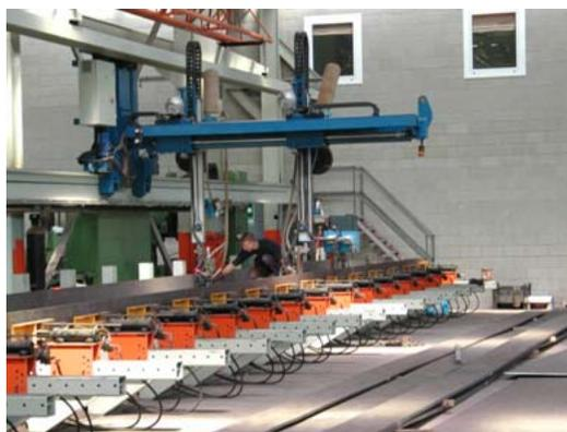
“H” ENSAMBLAJE Y SOLDADURA
