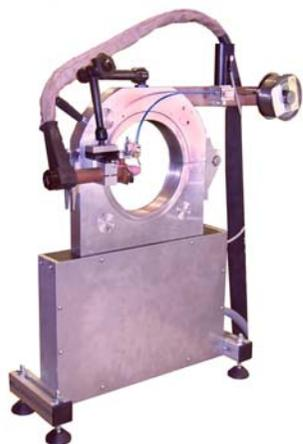
Desarrollo y fabricación de cabezales de soldadura orbital con aportación de hilo para el sector aeronáutico, capacidad hasta 170mm diámetro O.D., espesores de 0,4mm para calidades de material base como Inconel, Titanio, Aluminio, etc.
