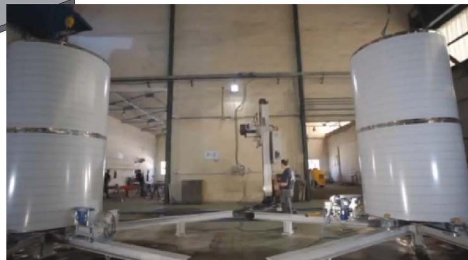
Instalación completa para la soldadura automática de depósitos en vertical, compuesta por :
