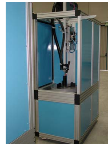
Soldadura circular Tig o plasma válvula botella gas
