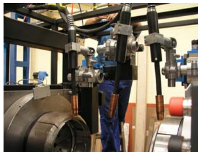
Soldadura Mig Pulsado – 3 arcos de soldadura simultáneos (cierre botella, asa y base de la botella)
