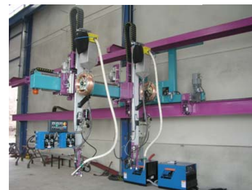
CARRO PARED SOLDADURA S.A.W.
